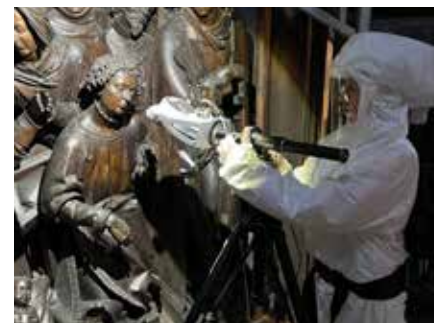
Röntgenfluoreszenz-Untersuchung zur Pigmentbestimmung
